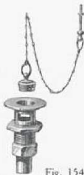
Fig. 154 Bonde à bouchon caoutchouc avec chaînette et borne d'attache, en cuivre nickelé, modèle à lanterne se montant sur nos lavabos à trop-plein combiné.
